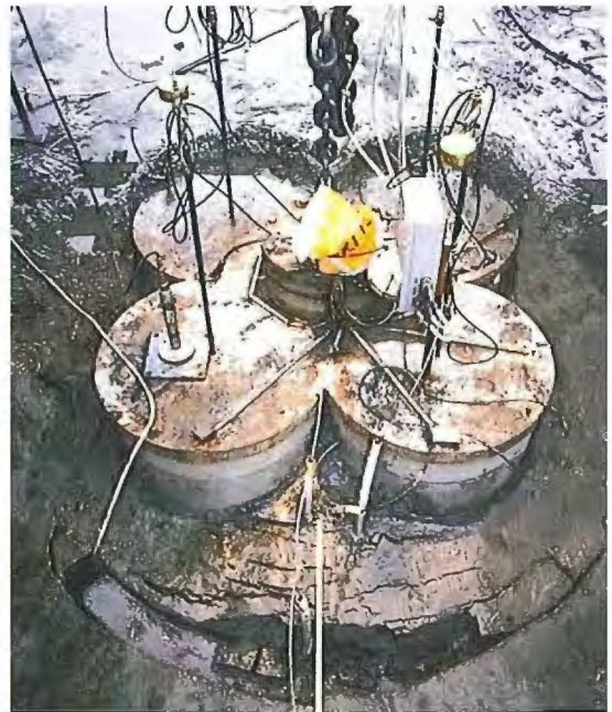
吸力锚模型测试
